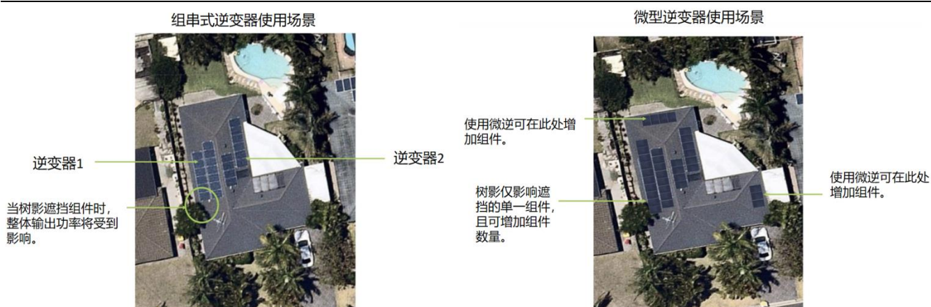
图 12：微型逆变器系统使户用屋顶光伏的使用更加灵活并增加发电效率
