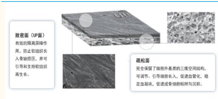
图表 22：海奥口腔修复膜双层微观结构
