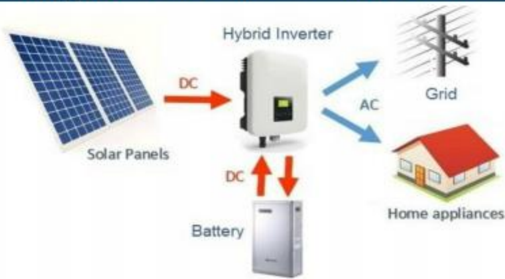
图：Hybrid集合太阳能发电与电池存储的关键功能
