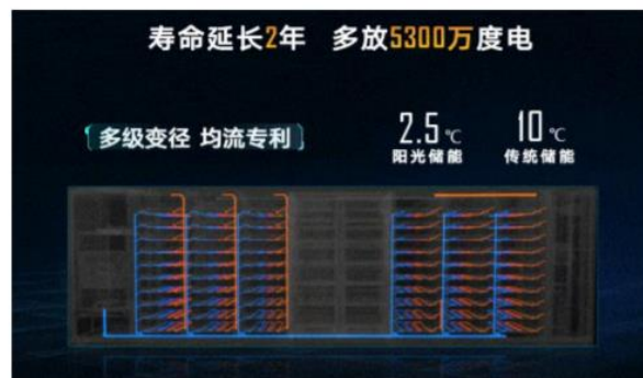
图表 25. 液冷系统显著提升储能系统寿命
