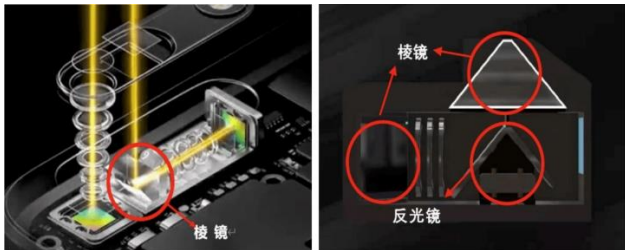
图47: 潜望式镜头原理
