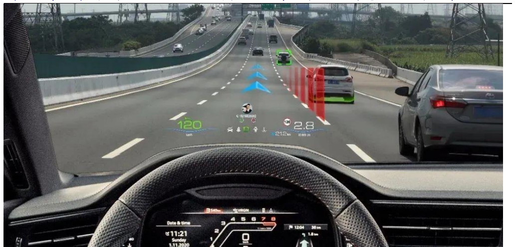
图21：华阳集团双焦面 AR-HUD 可实现远近景融合以达到更好的显示效果
