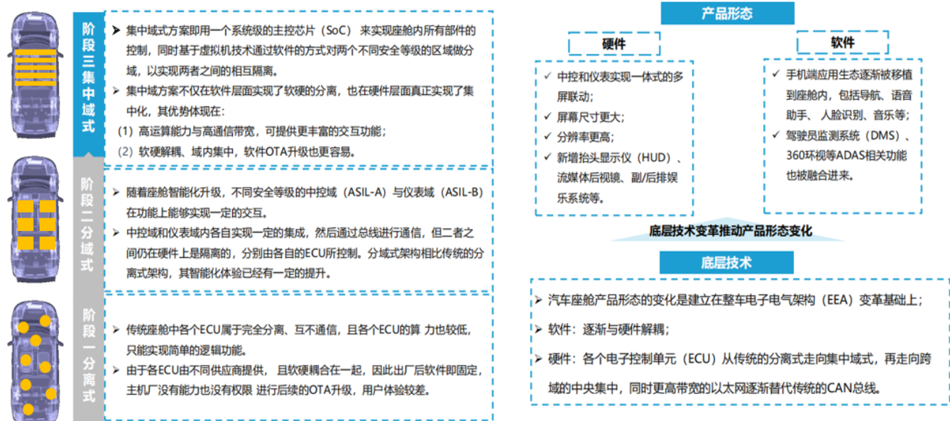
图14：座舱电子电气架构将呈集中域式
