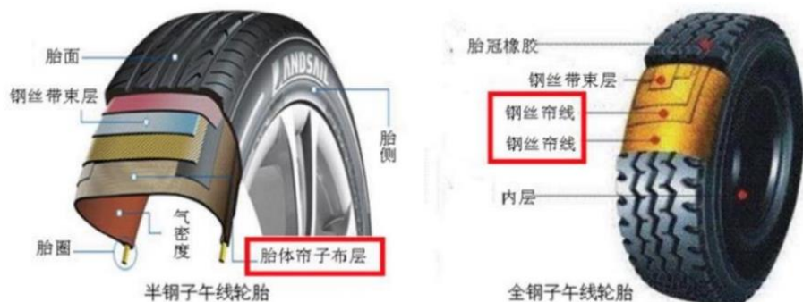
图13：全钢胎和半钢胎的结构图
