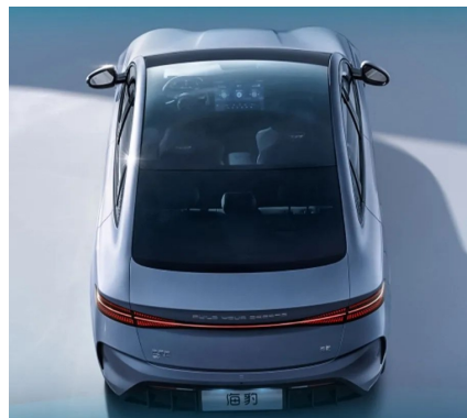
图 18: 比亚迪海豹搭载 EC 调光+LOW-E 全景天幕
