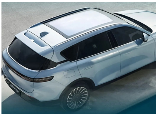
图 17: 岚图 FREE PDLC 调光+镀膜隔热全景天幕
