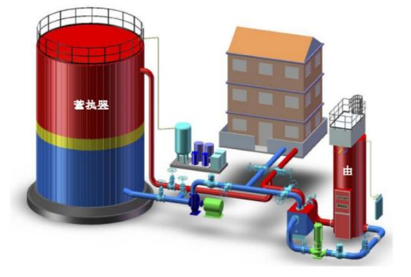
图 40：清洁能源消纳系统工艺图
