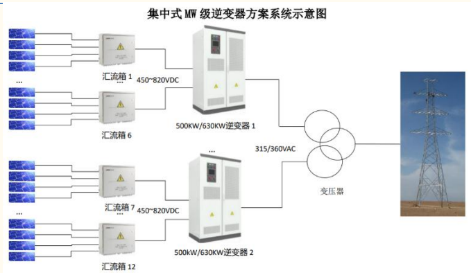
图表 24: 集中式逆变逆变器方案系统示意图
