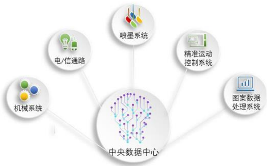
图 30：数码喷印设备架构需要集成多个系统
