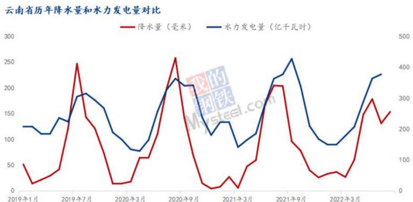
图39: 云南历年降水量和水力发电量对比
