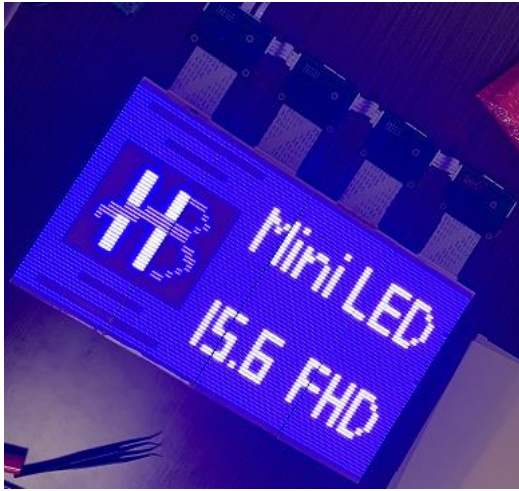
图表 32: 自研 15.6 寸 Mini LED 背光显示
