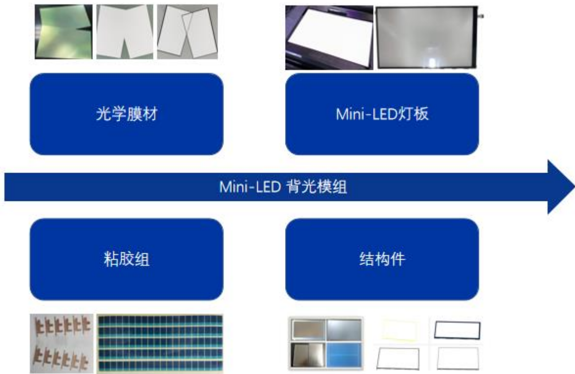
图表 34: Mini LED 背光模组制成
