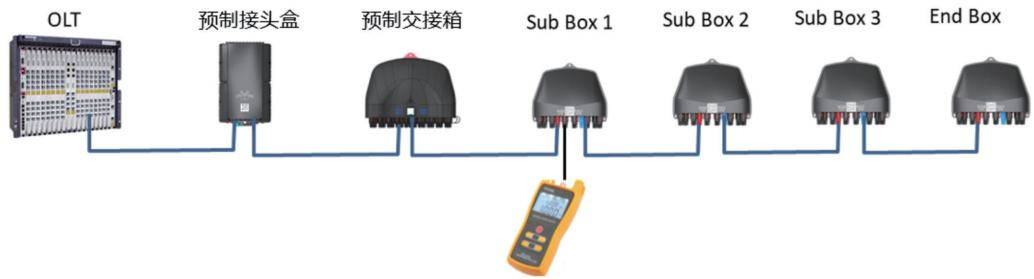
图 5-14 预连接 ODN 验收测试示意图
