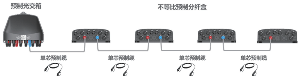
图 4-4 基于预连接技术的不等比组网示意图
