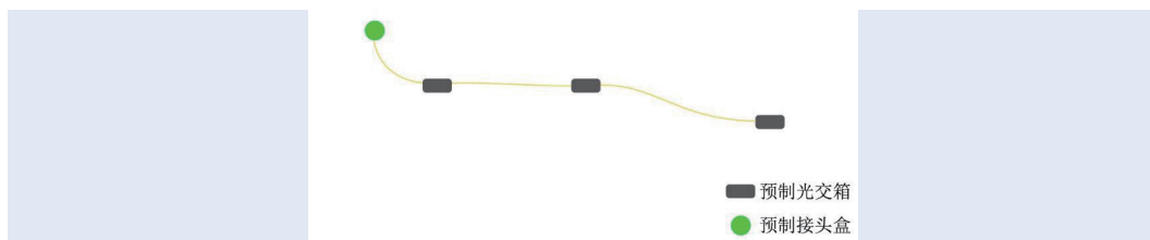
图 5-5 预制光交箱汇聚设计示意图
