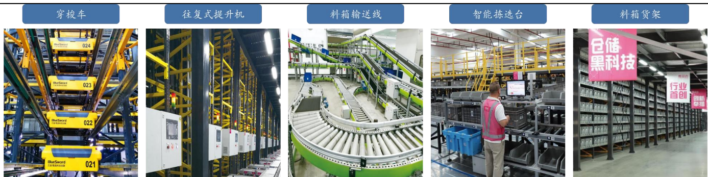
图表 31 公司料箱级密集仓储拣选一体化系统核心设备
