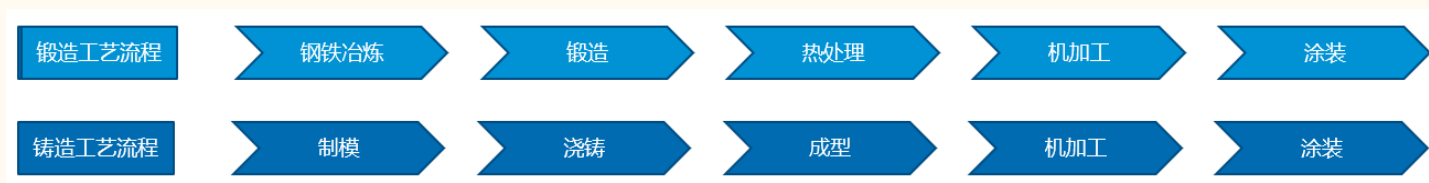
图表 14: 铸锻件主轴机加工和涂装工艺基本相同
