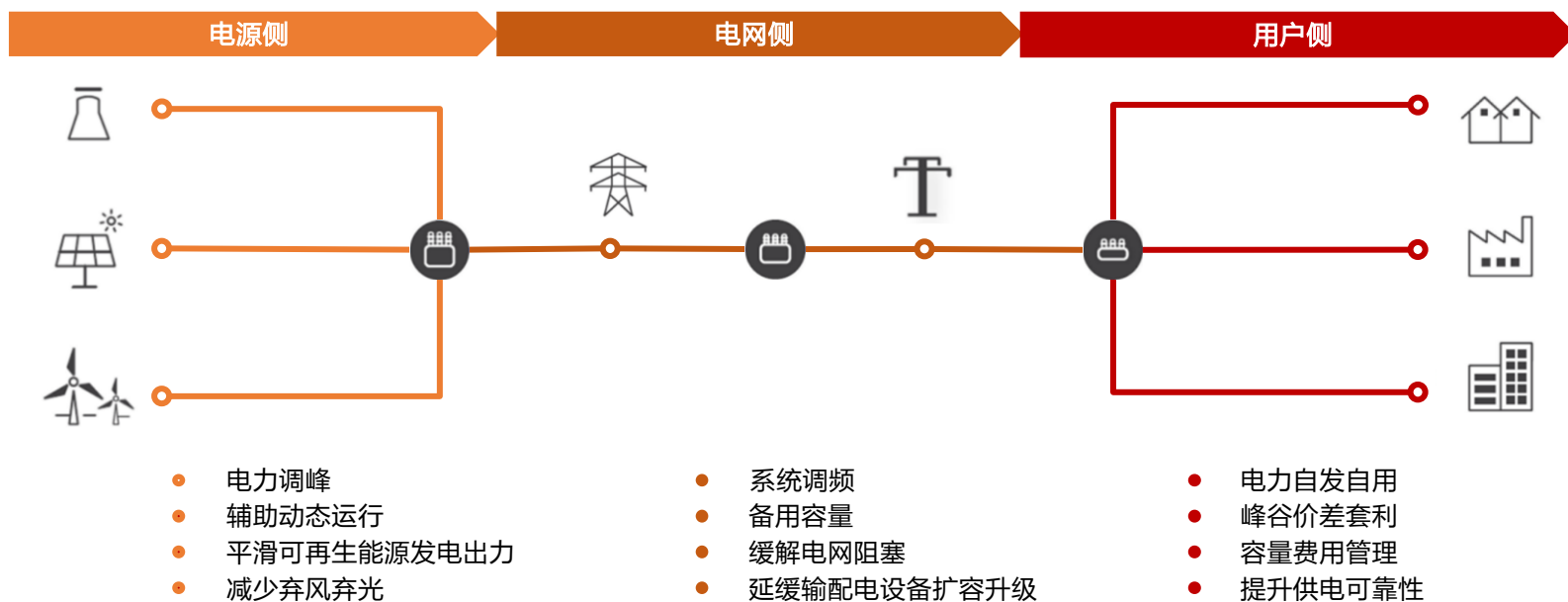
图：电力供应系统中电源侧、电网侧、用户侧对储能的需求
