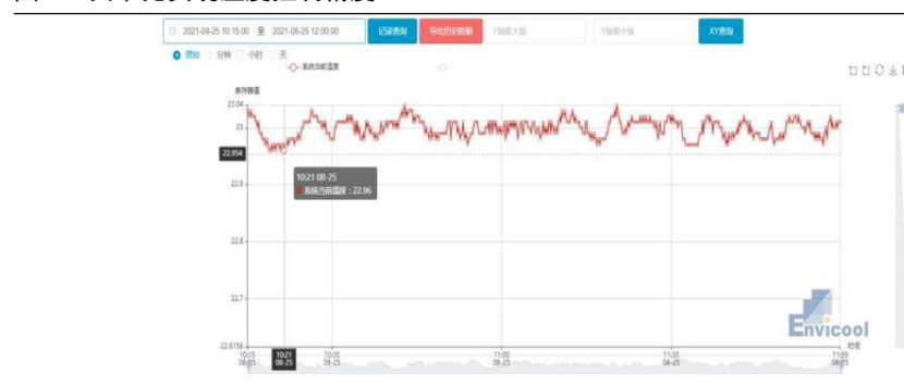
图 40: 英维克实现温度控制精度 23^{\circ}\text{C} \pm 0.05^{\circ}\text{C}
