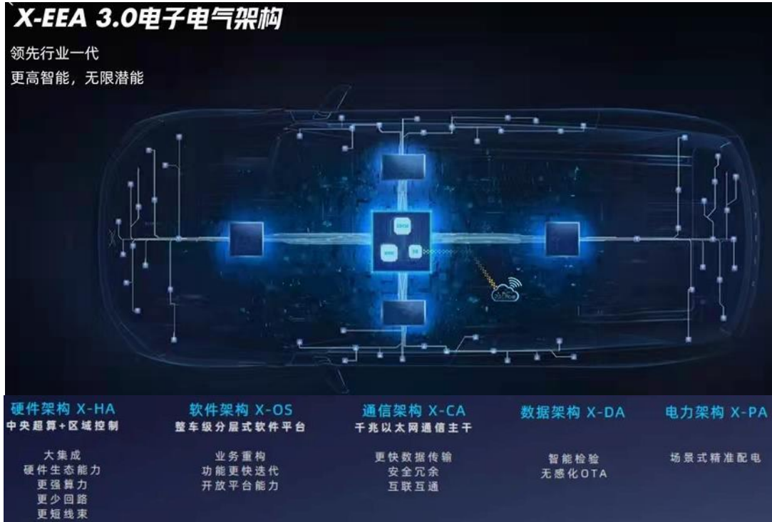
图表7 小鹏汽车第三代电子电气架构实现千兆以太网+中央计算+区域控制
