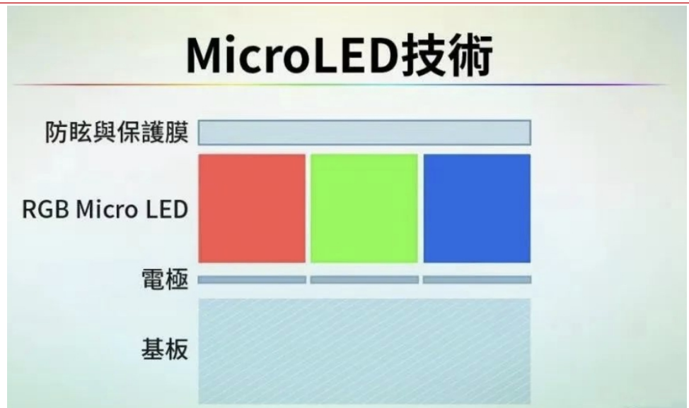
图 14：Micro-LED 技术原理
