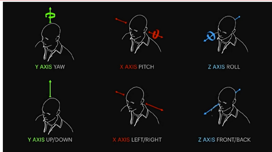
图 16：人的头部共包含 6 个自由度，6DoF 技术可实现头部位移检测
