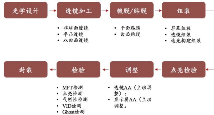
图 7：Pancake 光学模组工序
