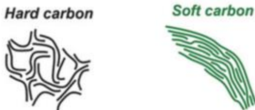
图 13. 软碳导电性较高，硬碳比容量较高
