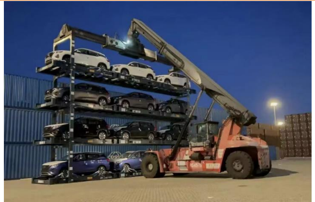
图 30：汽车装在框架箱内，适合装载到纸浆船里
