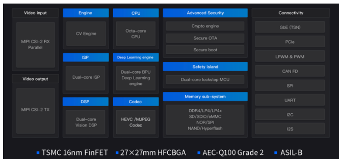
图表 18 地平线征程 5 芯片架构
