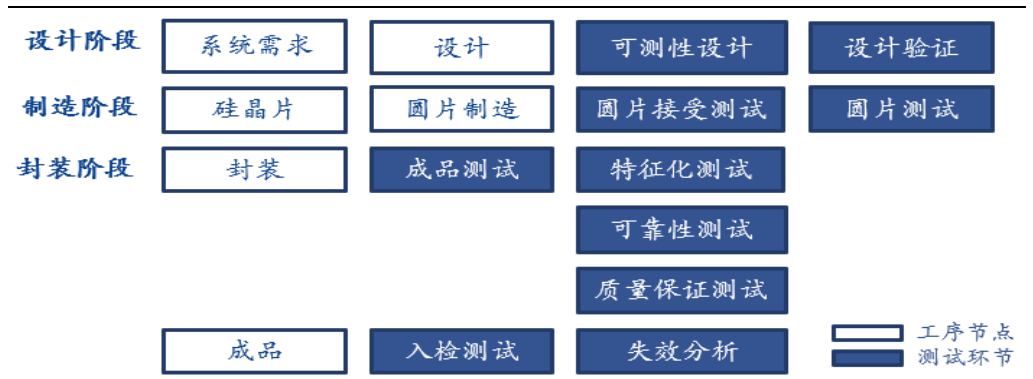
图2：测试贯穿于集成电路生产过程
