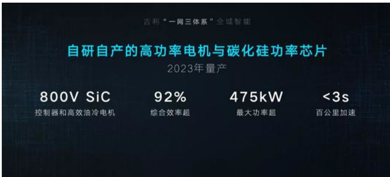
图 30：吉利汽车的高功率电机与碳化硅功率芯片
