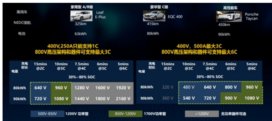
图 29：800V 架构下的充电速率大幅提升
