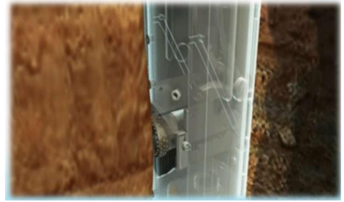
图表33: 高温大直径取心仪示意图
