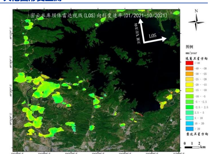
图 13：结合北斗/GNSS 与 InSAR 技术，对水利工程大范围形变监测
