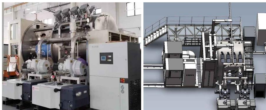
图44：东威科技锂电复合铜膜磁控溅射卷绕双面镀膜设备实拍图与建模图
