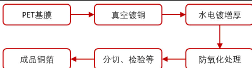
图42：PET 铜箔生产工序
