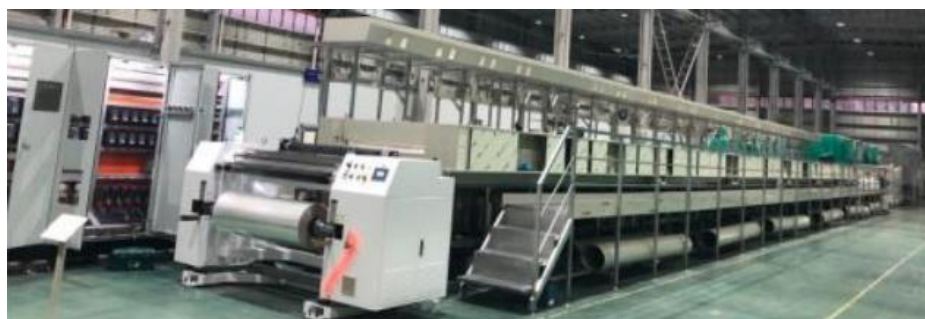
图46：东威科技卷式水平膜材电镀设备实拍图
