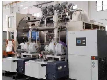
锂电复合铜膜磁控溅射卷绕双面镀膜设备，用于在柔性基材上离子源预清洗，附着层溅射，Cu金属层溅射，与公司已研发的薄膜电镀生产线密切对接
