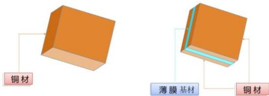
图表：复合铜箔和传统铜箔对比
