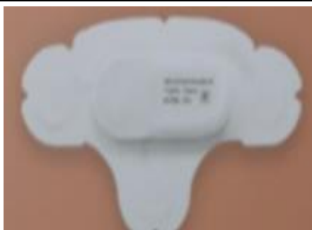
图38：心电监测设备采用锂原电池供电，无需频繁充电
