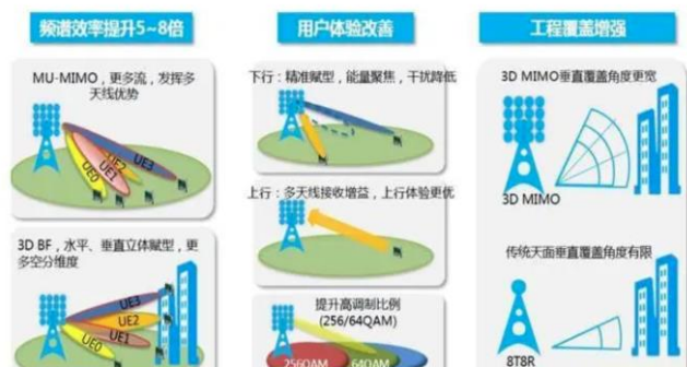
图 20: Massive MIMO 通过波束赋形提升网络覆盖能力
