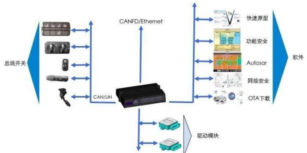
图 24：公司车身域控制器 BDCU 具体架构
