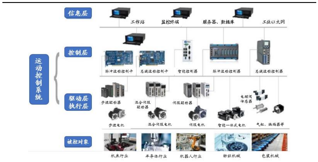
图34: 运动控制系统应用原理
