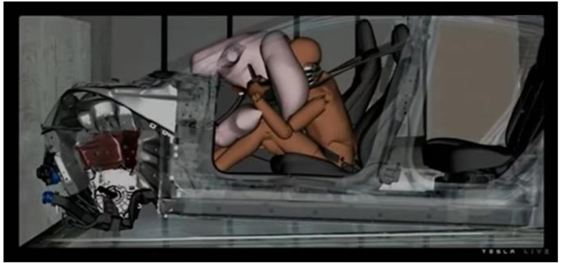
图15：特斯拉通过车祸安全模拟技术的迁移，来保证机器人碰撞损坏在可控范围内
