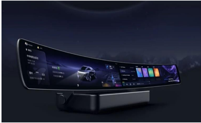
图 17：底特律车用显示展上的 23.6 英寸 Mini LED 曲面双联屏
