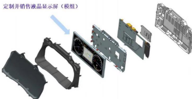
图12：液晶显示屏整机包含显示屏模组及电源电路、外壳等
