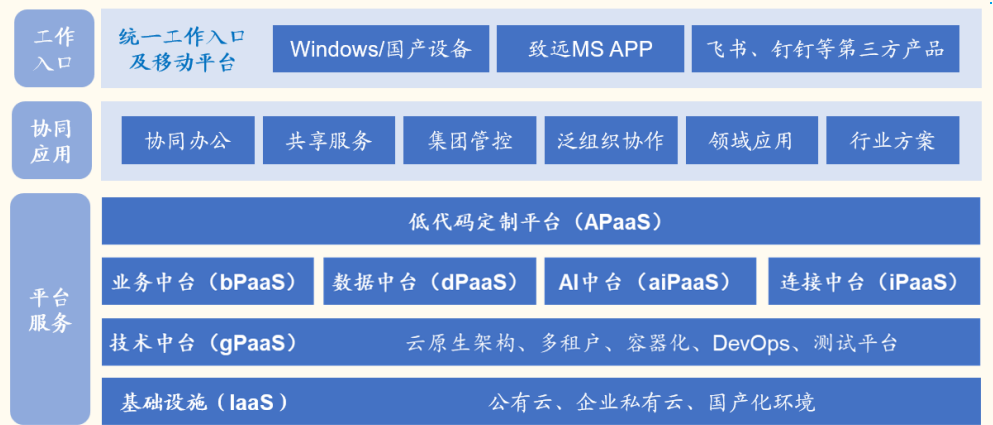
图表 18：公司新一代协同技术平台 V8 采用三层架构
