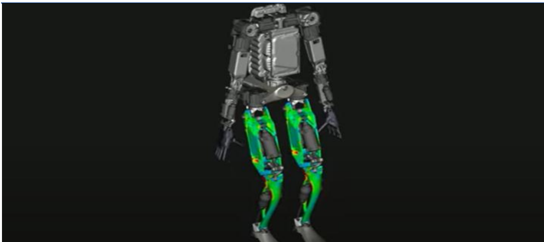
图 17：Optimus 人形机器人腿部元件易损性测试示意图
