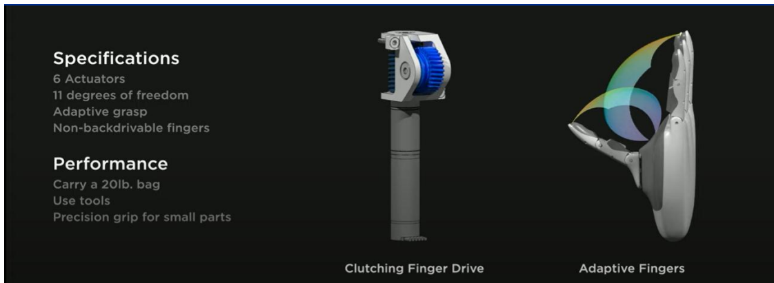
图 7: Optimus 人形机器人手部执行器与性能参数
