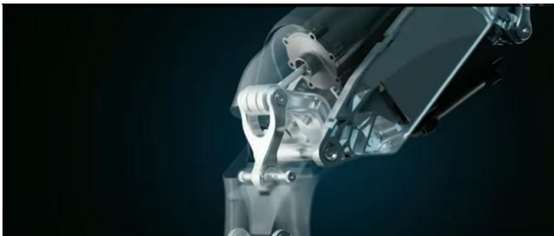
图 12: Optimus 人形机器人膝关节仿生结构设计
