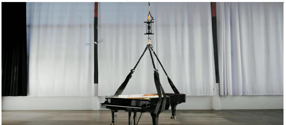
图 4: Optimus 人形机器人直线执行器吊起三角钢琴
