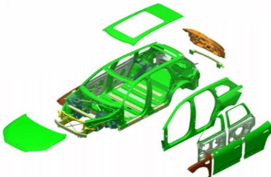
图 32 : ES8 复合材料的使用主要在背门盖
