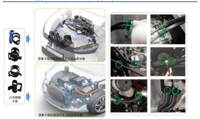
图 9：金属零部件主要为弹簧卡箍
