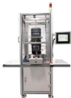
图24：线束端子超声波焊接设备
