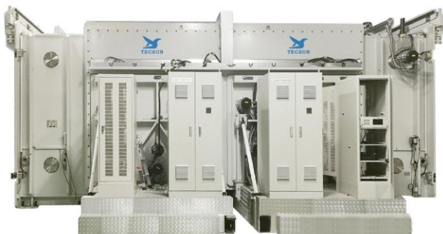
图5 卷绕式真空镀膜机
