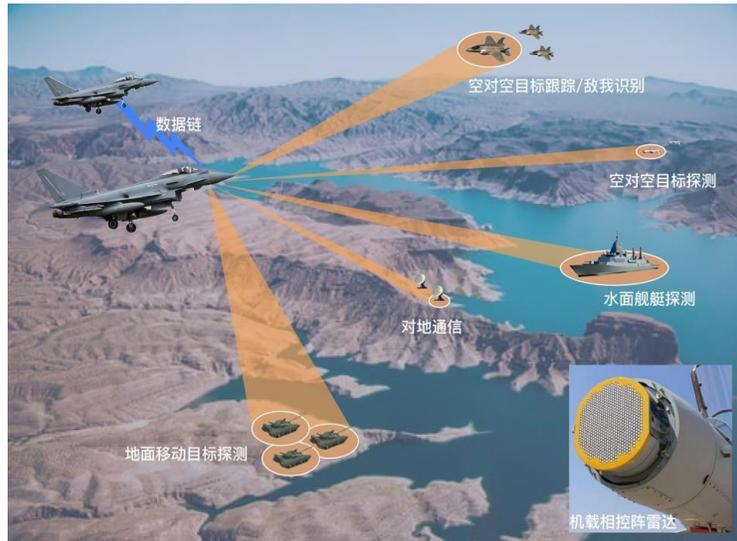
车载数字相控阵雷达多目标多点探测跟踪一体化工作示意图
