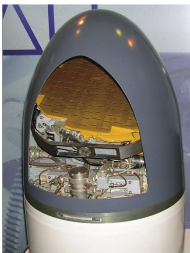
图 17：Kh-35 反舰导弹的雷达导引头
