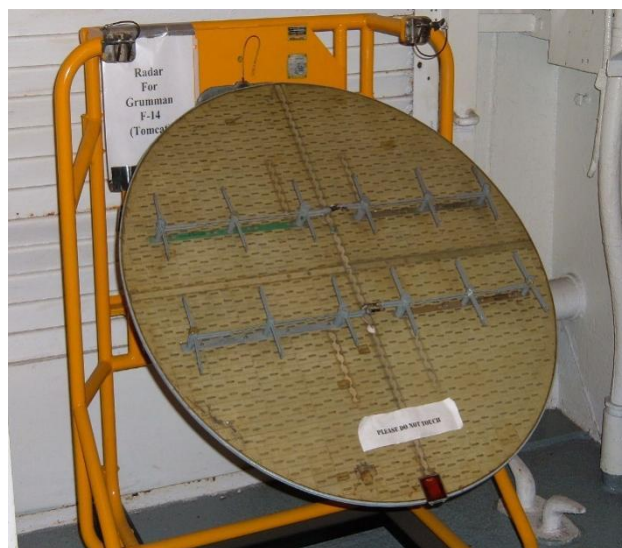
图 6：AWG-9 平面缝隙阵天线
