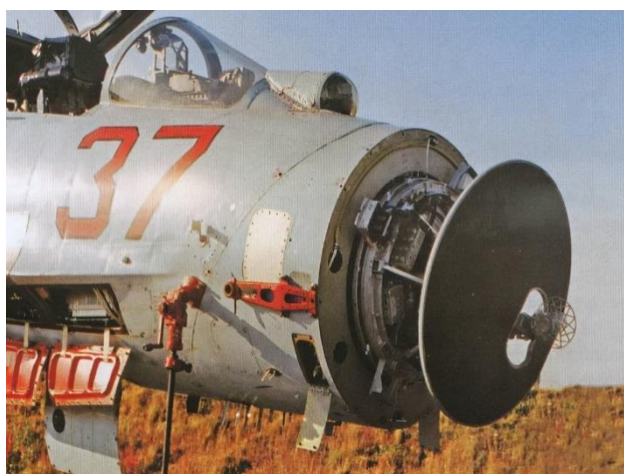
图 5：苏-27 的 RLPK-27 雷达的卡塞格伦天线
