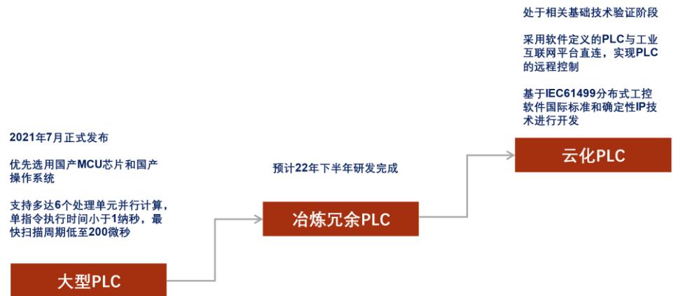
图38：宝信软件大型 PLC 产品的研发路线
