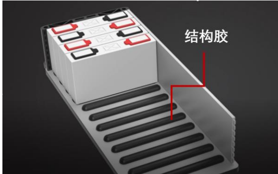
图 24：结构胶在动力电池中的应用
