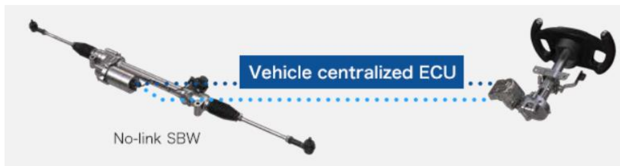
图13：线控转向系统的方向盘与转向器之间通过 ECU 传递指令
