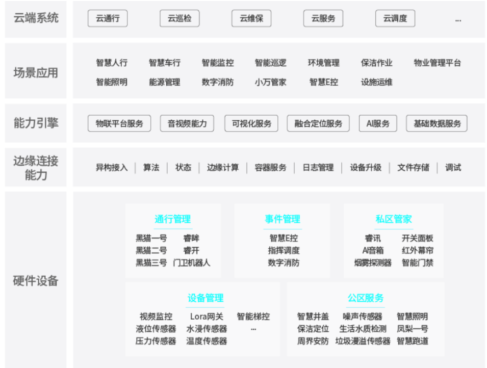
图 6: 万物云智慧社区产品方案架构
