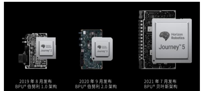
图 33：地平线征程系列芯片采用了 BPU 架构
