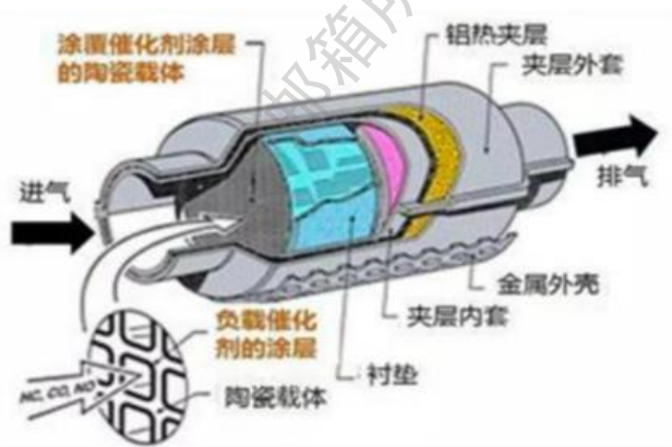
图表 22：尾气脱销催化分子筛应用示意图
