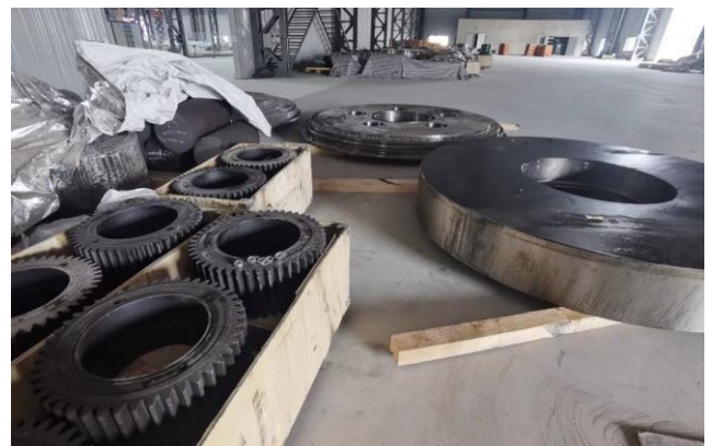
图20: 公司生产的风电齿轮箱齿轮零件
