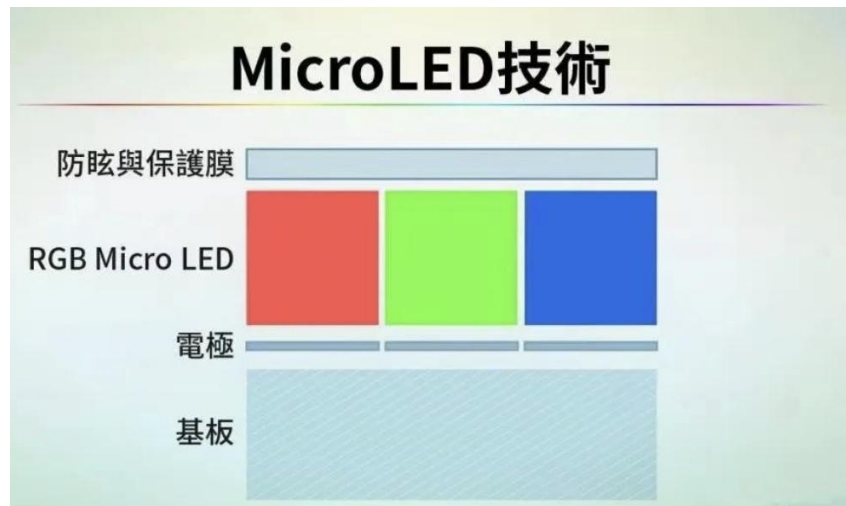
图 7: Micro-LED 技术原理
